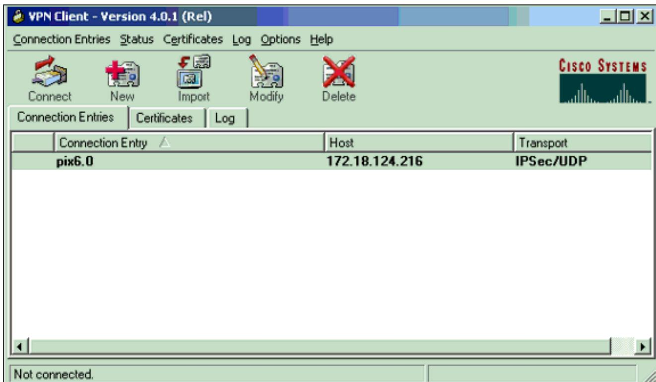
2. Insira as informações de configuração para a nova conexão. No campo Entrada de conexão, atribua um nome à sua entrada. No campo Host, insira o endereço IP da interface pública do PIX. Escolha a guia **Authentication** e insira o grupo e a senha (duas vezes - para confirmação). Quando terminar, clique em
