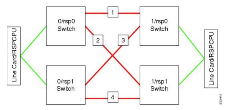
Para o 9001, há duas portas **de cluster** (ilustradas em verde) que atuam como os links EOBC de 10G. Qualquer porta 10G pode ser usada para links IRL, incluindo as portas SFP+ integradas (em azul) ou uma porta 10G em um Adaptador de porta modular (MPA).
