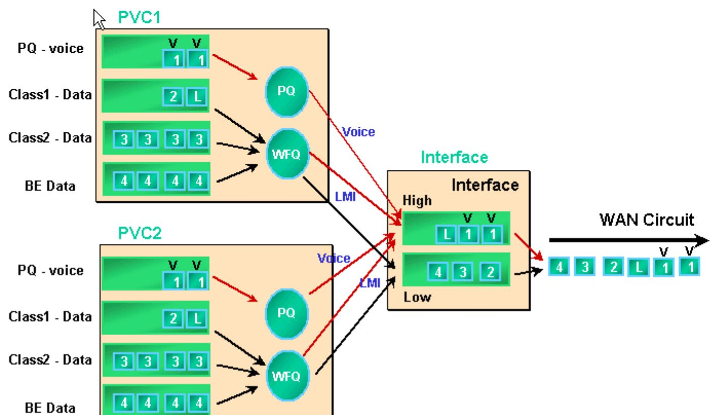
As interfaces do Frame Relay suportam filas de interface, bem como filas de PVC quando o enfileiramento de FRTS e PVC está ativado. Cada fila de PVC também suporta um sistema de WFQ (Weighted Fair Queuing) separado, se a fila de PVC estiver configurada como WFQ.
