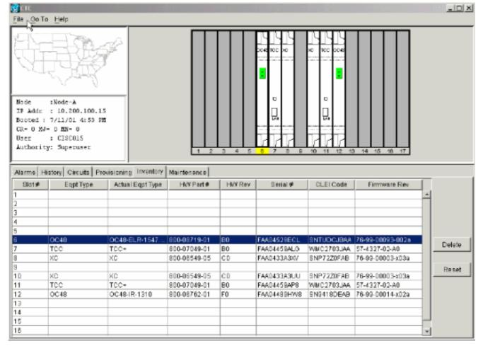
3. Se você tiver placas de linha OC-48 LR (OC48 LR 1550) com uma revisão de hardware 008C, precisará substituí-las antes de continuar com a atualização de software.
