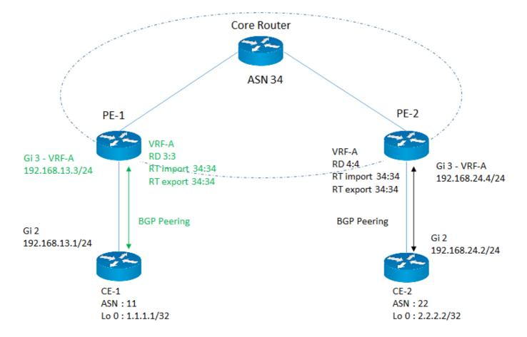
Neste exemplo, concentre-se na configuração dos parâmetros de serviço L3VPN MPLS necessários no roteador PE-1, que são destacados na cor rosa.
