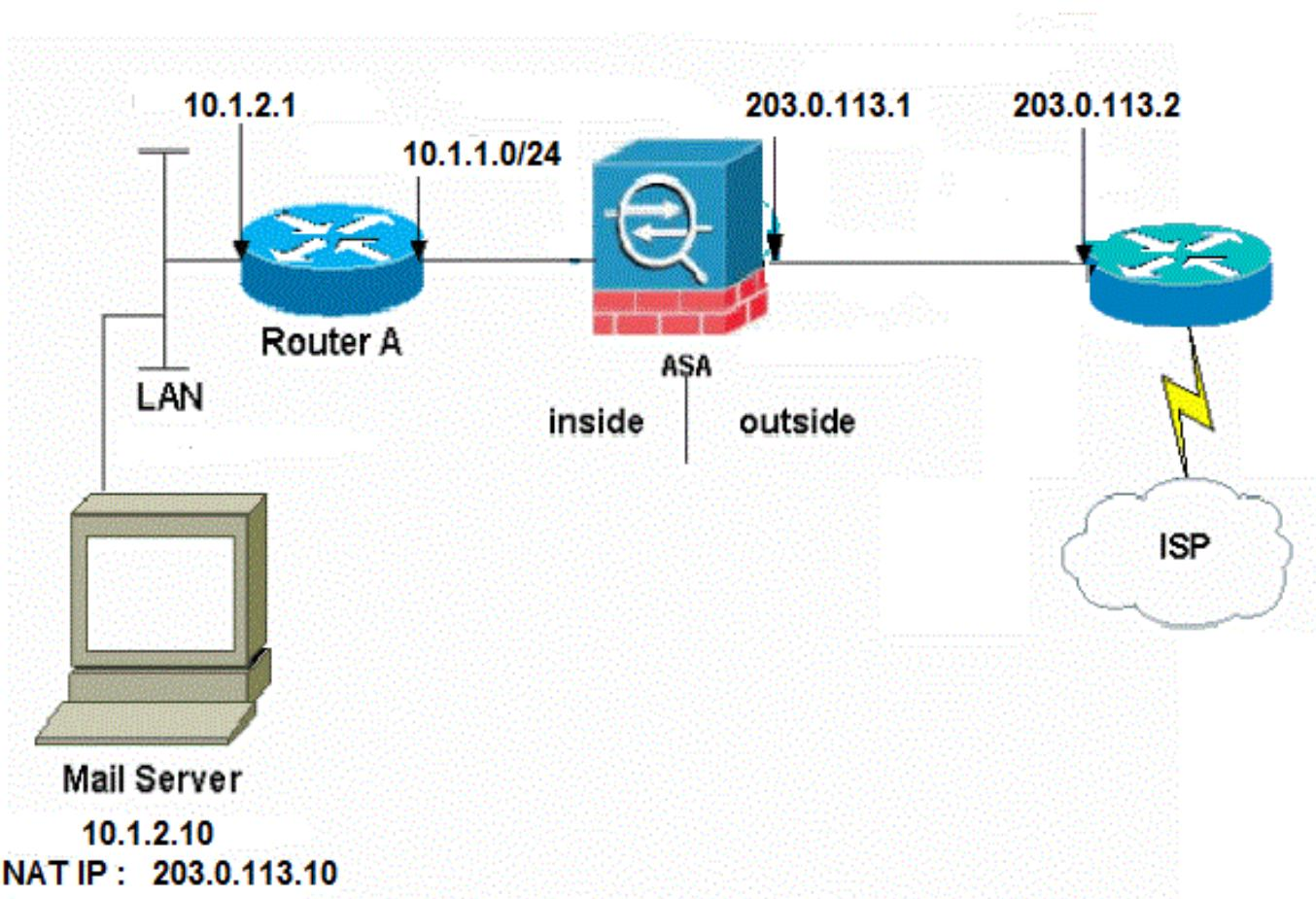
A configuração de rede usada neste exemplo tem o ASA com uma rede interna em 10.1.1.0/24 e uma rede externa em 203.0.113.0/24. O servidor de e-mail com o endereço IP 10.1.2.10 está localizado na rede interna.
