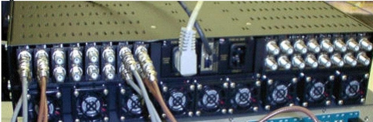
Os módulos são rotulados como A a P e correlacionam-se aos módulos 1 a 16, quando você estiver configurando as configurações no 7200. Os módulos na Figura 1 são mostrados da direita para a esquerda porque a Figura 1 é a visão traseira.
