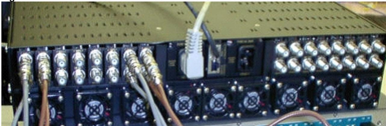
**Observação:** o conversor ascendente tem seu próprio recurso de redundância, mas não o habilita. Este recurso é para redundância de conversor superior quando um sinal IF é dividido para alimentar dois módulos de conversor ascendente adjacentes e a saída de RF é combinada através de um divisor. O SNMP cuida deste recurso de redundância de conversor ascendente.
