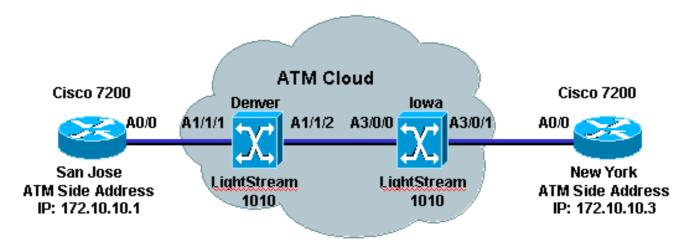
O provedor de serviços ATM deve fornecer as informações de VPI/VCI que ambos os dispositivos finais usam para configurar um PVC. Os pares VPI/VCI não precisam ser os mesmos. O provedor de serviços ATM configura conexões cruzadas nos switches entre os pares VPI/VCI.
