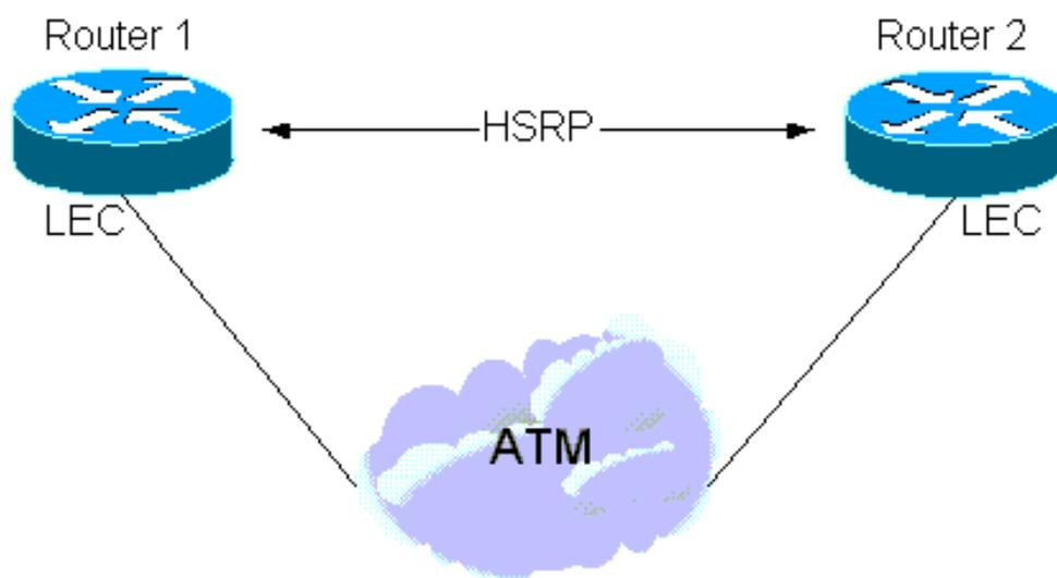
2. Há também uma instância em que o HSRP é configurado em interfaces de LAN, mas parte da sub-rede abrange uma nuvem LANE. Isso é feito pelo intermediário de um switch LAN com uma interface ATM (como um Cisco Catalyst 5000 com um módulo LANE). Veja a seguinte ilustração.
