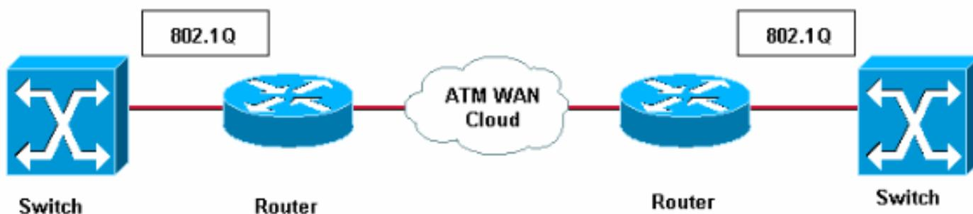
Entretanto, existe uma maneira alternativa de construir VLANs de ponta a ponta. Configure ambos os roteadores com o mesmo conjunto de grupos de pontes e subinterfaces 802.1Q. Em outras palavras, as duas extremidades do roteador têm um mapeamento um a um entre um
