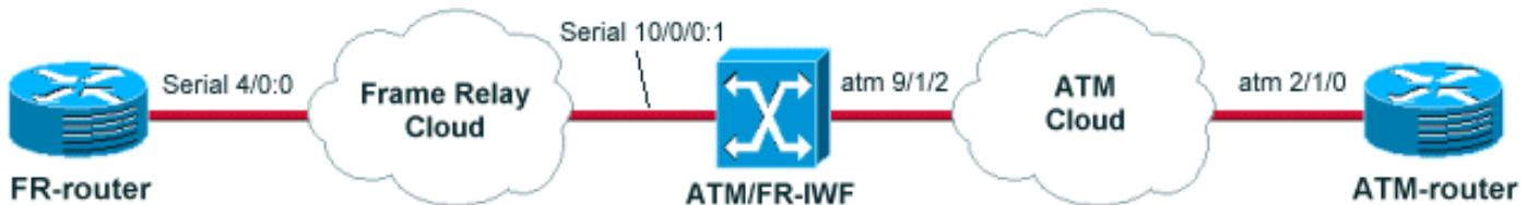
**Observação:** o roteador ATM é um roteador 7500 usando um PA-A3-OC3MM em um VIP2-50 e executando 12.1(13)E. O roteador FR é um roteador 7200 executando 12.1(17). O Switch ATM/FR-IWF é um catalyst 8540MSR executando o 12.1(12c)EY.
