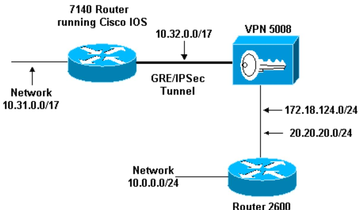
GRE over IPSec wordt geconfigureerd tussen de Cisco IOS-router (7140) en Cisco VPN 5008 Concentrator. Achter deze apparaten worden meerdere netwerken geadverteerd via RIP, die binnen de GRE-tunnel tussen 7140 en VPN 5008 loopt.
