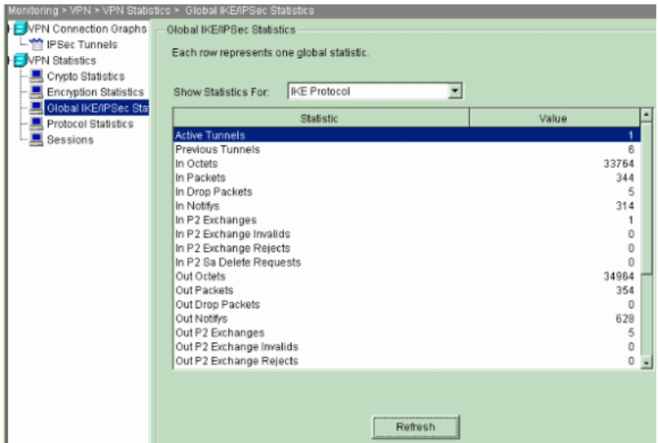
U kunt ook de vorming van tunnels met CLI controleren. Geef de opdracht **show crypto isakmp** als opdracht uit om de vorming van tunnels te controleren en de **show crypto ipsec** als opdracht uit te geven om het aantal ingekapselde, gecodeerde pakketten, enzovoort te observeren.
