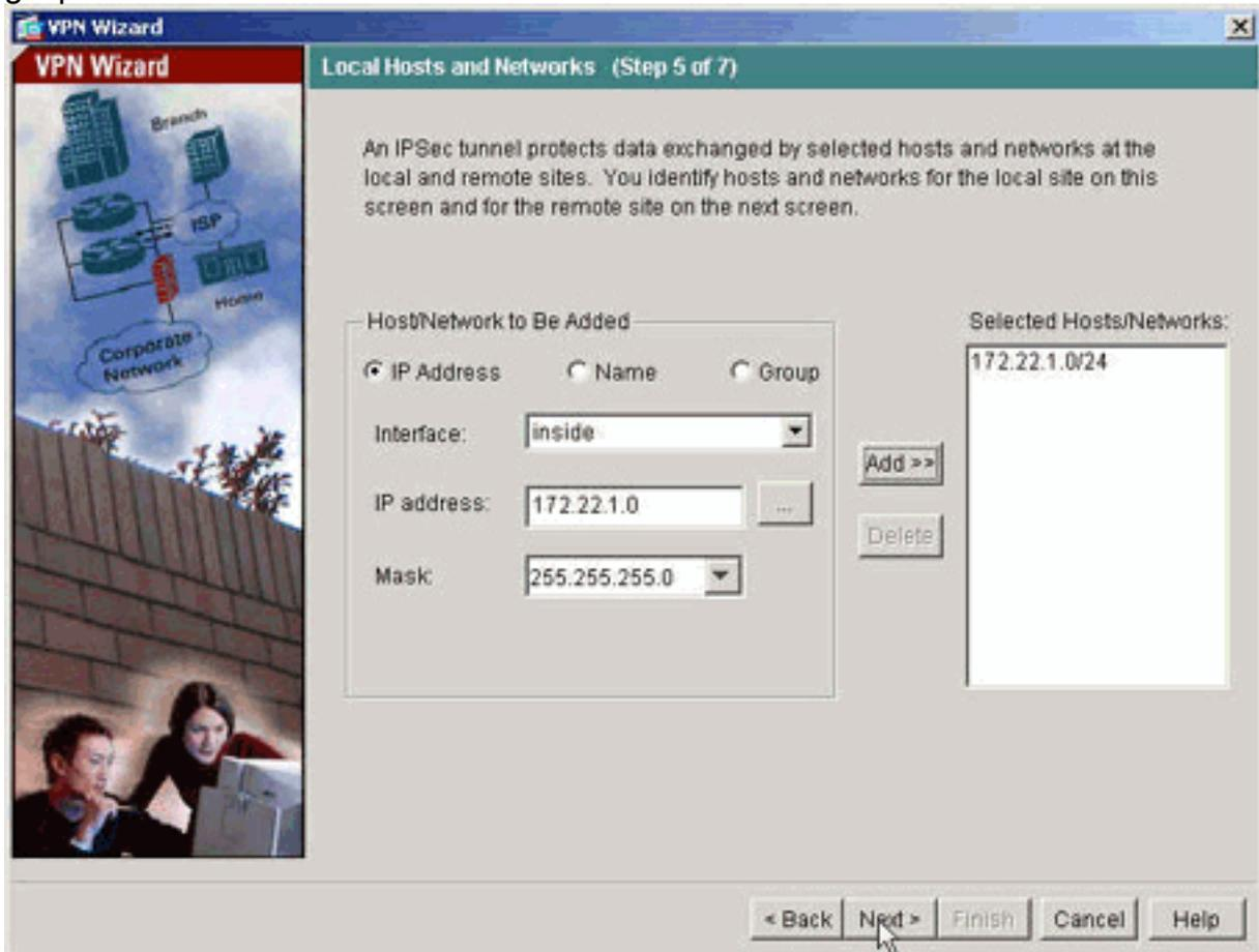
11. De hosts en netwerken aan de afgelegen zijde van de tunnel worden gespecificeerd.
