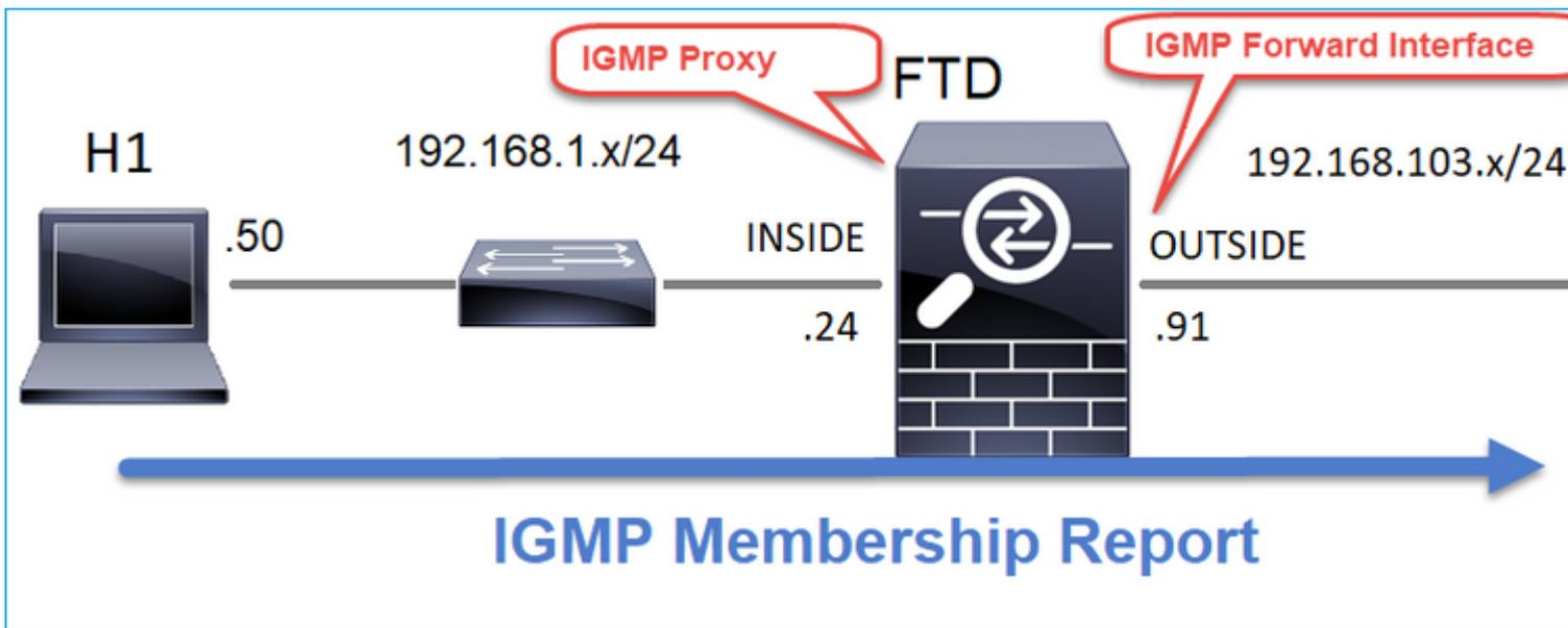
Configureer stub multicast routing op FTD zodat IGMP Membership Report-berichten die op de BINNENKANT-interface worden ontvangen, naar de BUITENinterface worden doorgestuurd.
