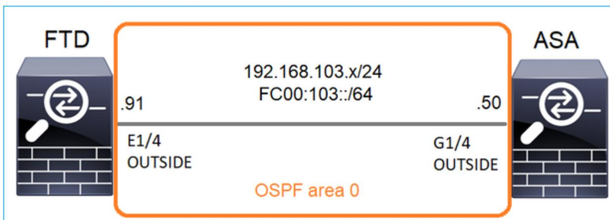
Configureer een OSPFv2 en OSPFv3 tussen de FTD en de ASA. Controleer hoe de 2 apparaten L2 en L3 Multicast verkeer behandelen dat door OSPF wordt geproduceerd.
