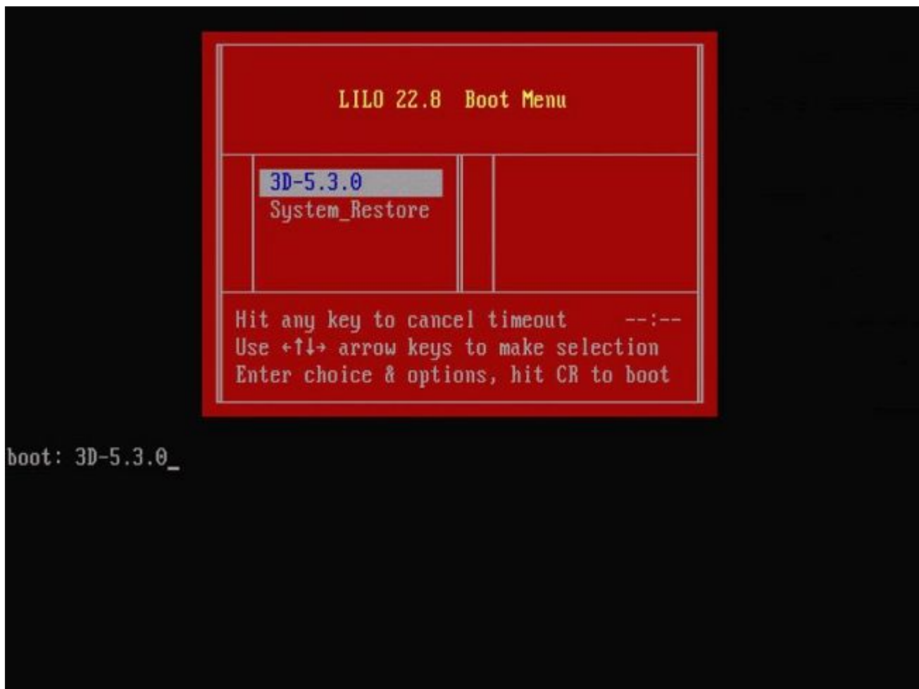
Afbeelding 2 - Wanneer het systeem opnieuw opgestart wordt, drukt u op een pijltjestoets op het toetsenbord om het aftellen te stoppen en de optie System_Restore te kiezen voor het volgende scherm dat wordt
