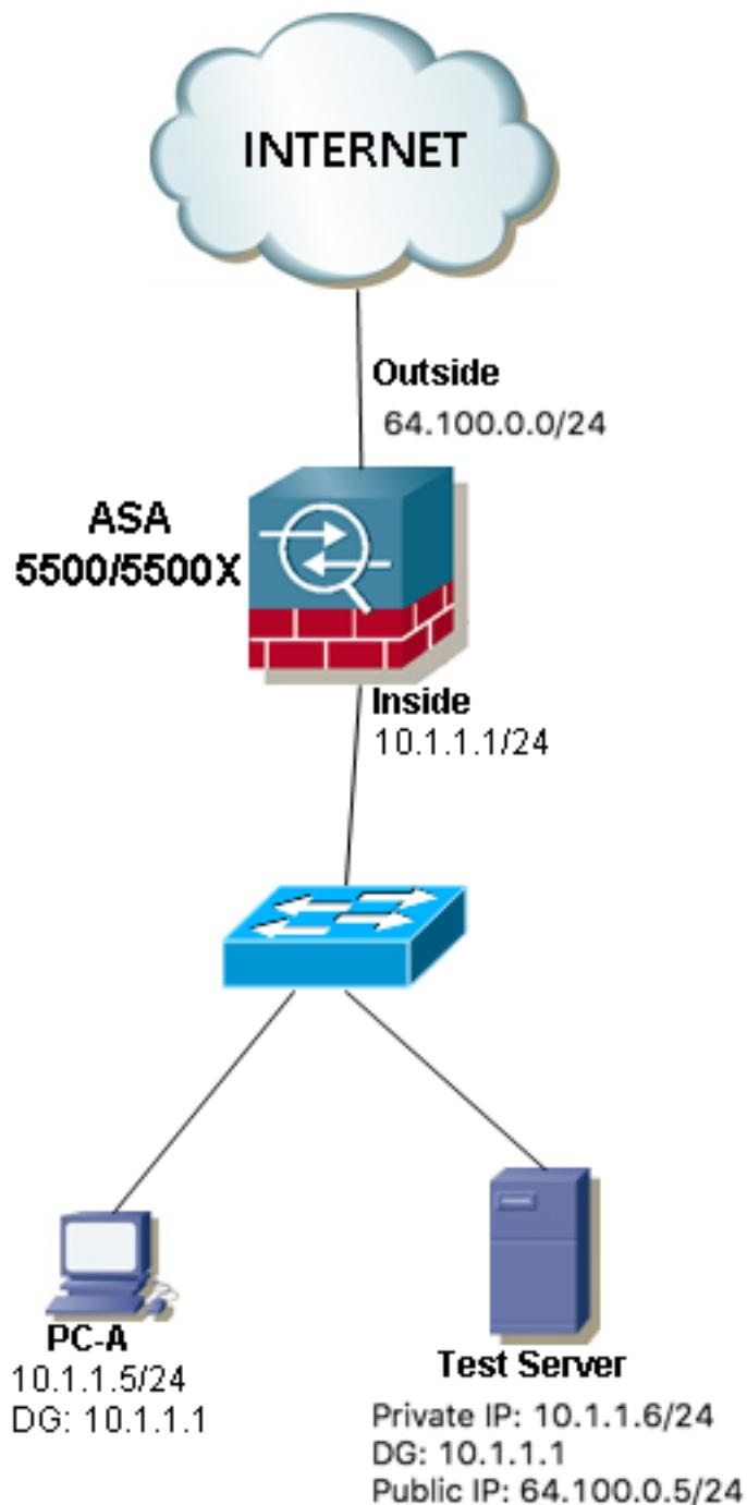
Voorbeeld 3. De bron- en doelgastheren PC-A en Test Server worden verbonden met de binnen-ASA interface, maar achter een ander laag 3 apparaat (het kan een router of een meerlaagse switch zijn).
