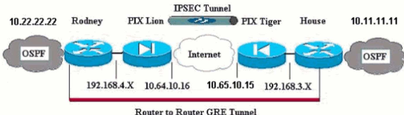
**Opmerking:** de IP-adresseringsschema's die in deze configuratie worden gebruikt, zijn niet wettelijk routeerbaar op het internet. Dit zijn [RFC 1918](#) adressen die in een labomgeving gebruikt
