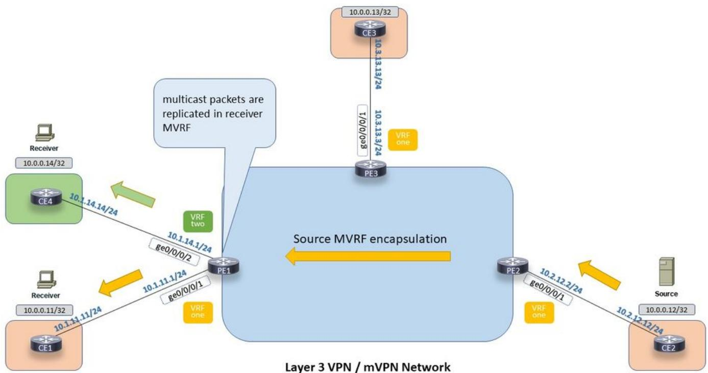
VPN-extranet op IOS-XR: Multicast voor Packet Flow optie 1
