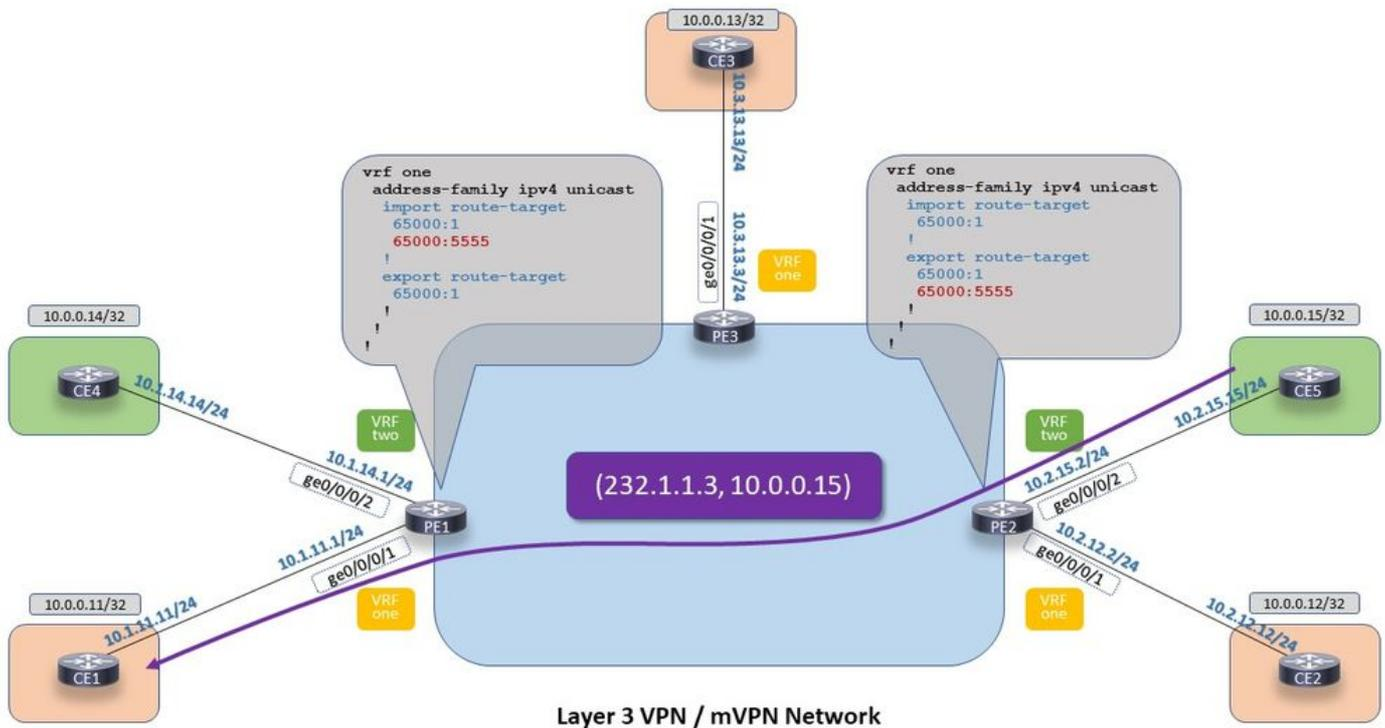
VPN-extranet op IOS-XR: Profiel 0 - Optie 1 De bron MVRF is op de ontvanger MVRF
