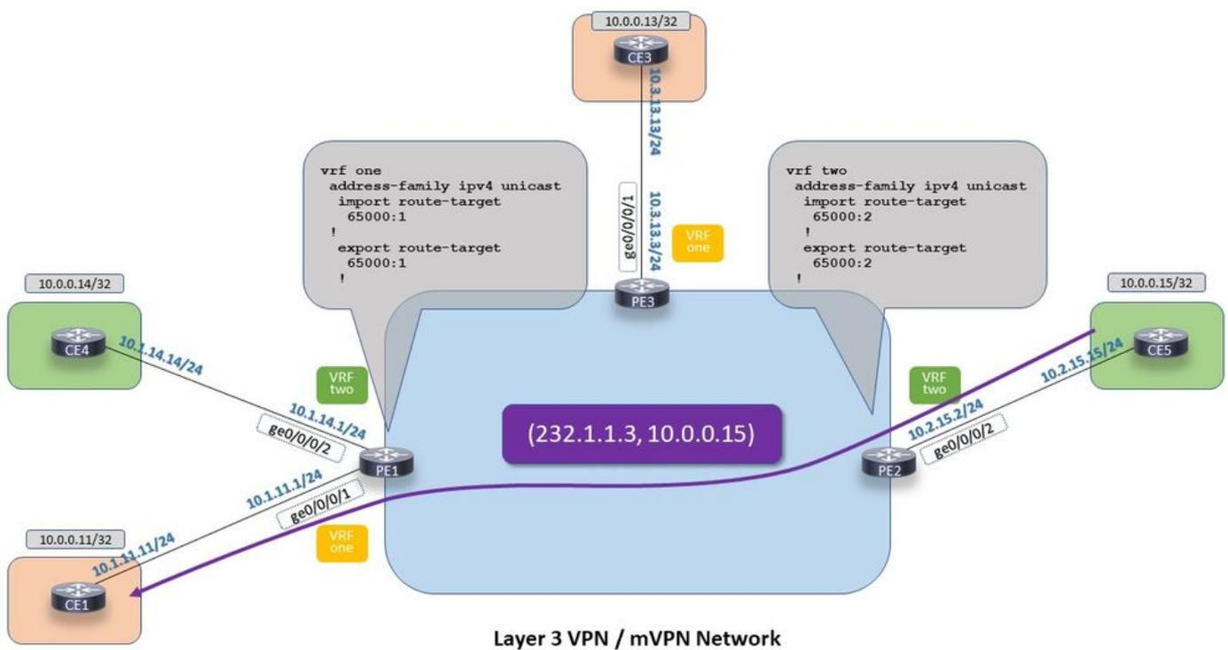
VPN-extranet op IOS-XR: Profiel 14 - Optie 1 De bron MVRF is op de ontvanger MVRF
