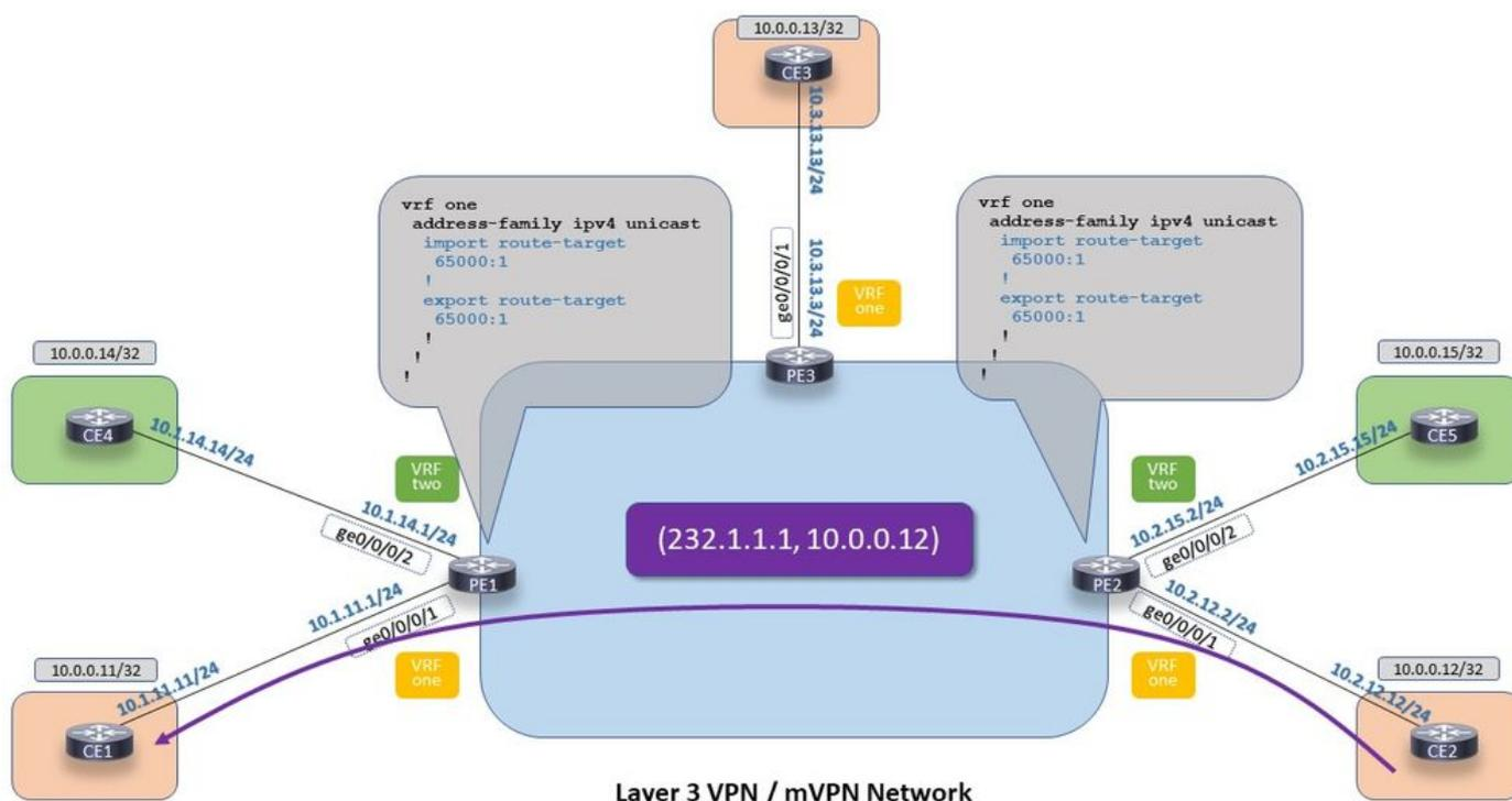
VPN-extranet op IOS-XR: Multicast voor pakketstromen voor intranet MVRF
