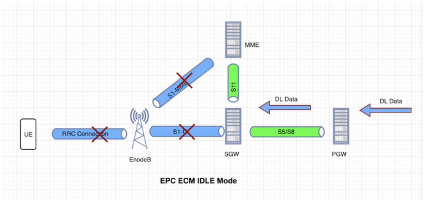
ECM-IDLE 모드에는 인터넷에서 UE를 위한 DL 데이터가 있을 수 있습니다. 이러한 패킷은 먼저 PGW에 도달합니다. PGW는 바이트의 적절한 어카운팅 후에 이러한 패킷을 SGW에 전달합니다. SGW에서 데이터를 수신하면 수신 패킷을 버퍼링합니다. UE가 유휴 모드임을 확인한 후 MME에 대한 DDN(Downlink Data Notification) 절차를 시작하고 MME가 UE에 대한 페이징을 시작합니다.
