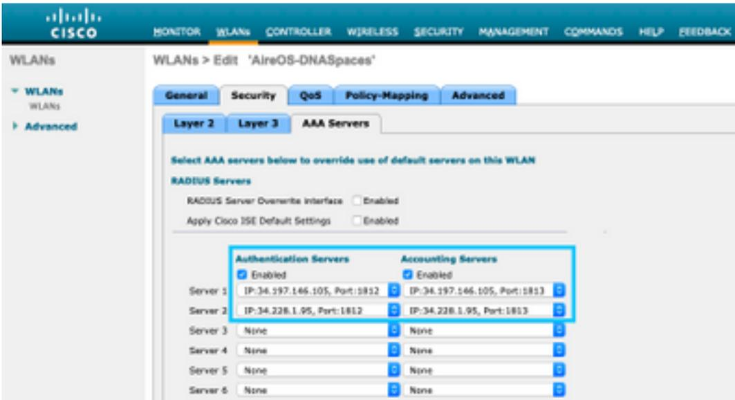
6단계. 웹 인증 사용자에게 대한 인증 우선 순위 순서를 구성합니다. WLAN Configuration(WLAN 컨피그레이션) 탭에서 Security(보안) > AAA Servers(AAA 서버) 탭으로 이동하고 RADIUS를 순서대로 첫 번째로 설정합니다.
