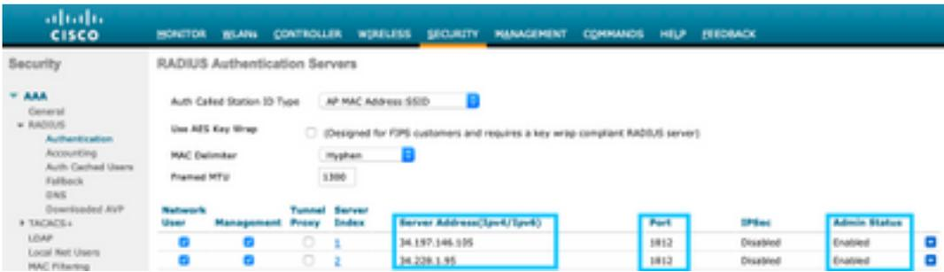
**참고:** 기본 및 보조 서버 모두에 대한 RADIUS IP 주소와 비밀 키를 가져오려면 **DNA Spaces**에서 SSID 생성 섹션의 3단계에서 생성한 SSID에서 **Configure Manually(수동으로 구성)** 옵션을 클릭하고 **RADIUS Server Configuration(RADIUS 서버 컨피그레이션)** 섹션으로 이동합니다.
