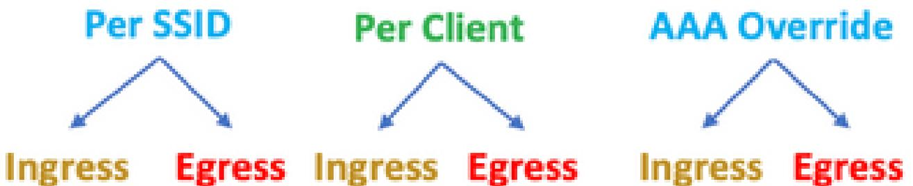
예를 들어 QoS 정책은 게스트 WLAN에 연결되는 정책 프로파일에 Ingress(인그레스) 및 Egress(이그레스) 양방향으로 SSID당 적용되어야 합니다.
