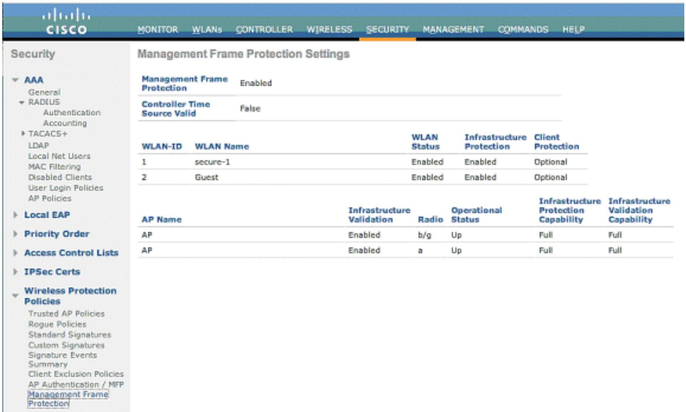
MFP Settings(MFP 설정) 페이지에서 WLC, LAP 및 WLAN의 MFP 컨피그레이션을 확인할 수 있습니다. 이것은 예시이다.
