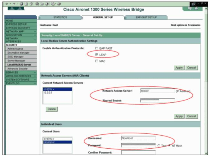
Individual Users(개별 사용자) 영역에서 개별 사용자를 정의하고 Apply(적용)를 **클릭합니다**.구성하는 사용자 이름과 비밀번호는 LEAP 클라이언트의 사용자 이름과 비밀번호와 일치해야합니다.이 예에서는 이러한 필드가 비루트 브리지의 사용자 이름과 비밀번호와 일치해야합니다.예제 사용자 이름은 *NonRoot*이고 비밀번호는 *Cisco123입니다.*참고: 그룹은 선택 사항입니다.그룹 특성은 Active Directory에 전달되지 않으며 로컬에서만 관련됩니다.기본 컨피그레이션이 올바르게 작동하는지 확인한 후 나중에 그룹을 추가할 수 있습니다.
