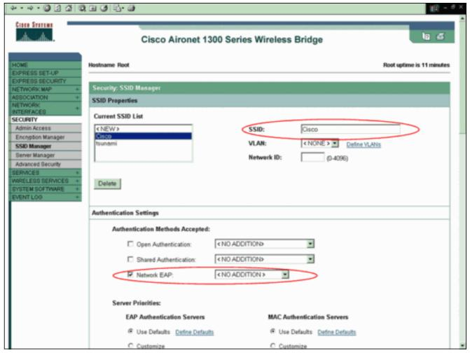
**참고**: Cisco IOS Software Release 12.3(4)JA 이상에서는 SSID를 전역으로 구성한 다음 특정라디오 인터페이스에 적용합니다.SSID를 <u>전역적으로 구성하려면 Configuring Multiple SSIDs(</u>여러 SSID 구성) 문서의 Creating an SSID Globally(SSID 전역 생성) 섹션을 참조하십시오.또한 Cisco IOS Software Release 12.3(7)JA에서는 기본 SSID가 없습니다.아래로 스크롤하여 Global Radio0-802.11G Properties(전역 Radio0-802.11G 속성) 영역으로 이동하여 다음 단계를 완료합니다
