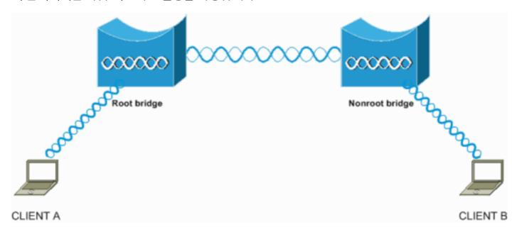
이 설정은 두 개의 Aironet 1300 Series Wireless Bridge를 사용합니다.브리지 중 하나가 루트 브리지 모드에 대해 구성되고 다른 브리지는 비루트 브리지 모드에 대해 구성됩니다.클라이언트 A는 루트 브리지와 연결되고 클라이언트 B는 루트가 아닌 브리지와 연결됩니다.모든 디바이스는 네트워크 다이어그램에 표시된 대로 10.0.0.0/24 범위의 IP 주소를 사용합니다.이 컨피그레이션은 브리지간에 포인트 투 포인트 무선 연결을 설정합니다.무선 브리지가 통신할 수 있으려면 먼저 서로 인증해야 합니다.브리지는 다음 인증 방법 중 하나를 사용합니다.
