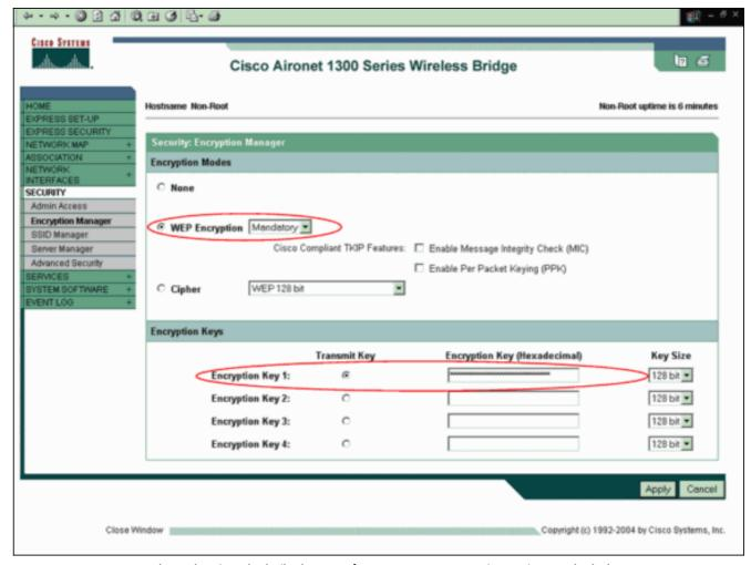
Encryption Keys(암호화 키) 영역에서 **128비트**를 Key Size(키 크기)로 선택하고 Encryption Key(암호화 키)를 입력합니다.루트 브리지에서 사용한 것과 동일한 WEP 암호화 키를 사용해야 합니다.이 예에서 암호화 키는 1234567890abcdef1234567890입니다.
