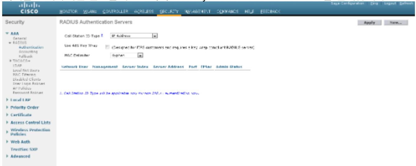
RADIUS 서버 매개변수를 정의하려면 New(새로 만들기)를 클릭합니다. 이러한 매개변수에는 RADIUS 서버 IP 주소, 공유 암호, 포트 번호 및 서버 상태가 포함됩니다. Network User and Management(네트워크 사용자 및 관리) 확인란은 RADIUS 기반 인증이 관리 및 네트워크 사용자에게 적용되는지 결정합니다. 이 예에서는 Cisco Secure ACS를 IP 주소가 10.104.208.56인 RADIUS 서버로 사용합니다
