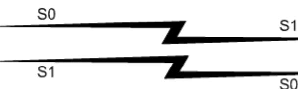
라우터 Montecito와 Goleta는 Serial0 및 Serial1 인터페이스를 통해 다시 연결됩니다. 이 구성에서는 각 측의 Virtual-Template, PPP(Multilink Point-to-Point Protocol), 브리지 및 라우터 간 IP 및 IPX를 라우팅합니다.
