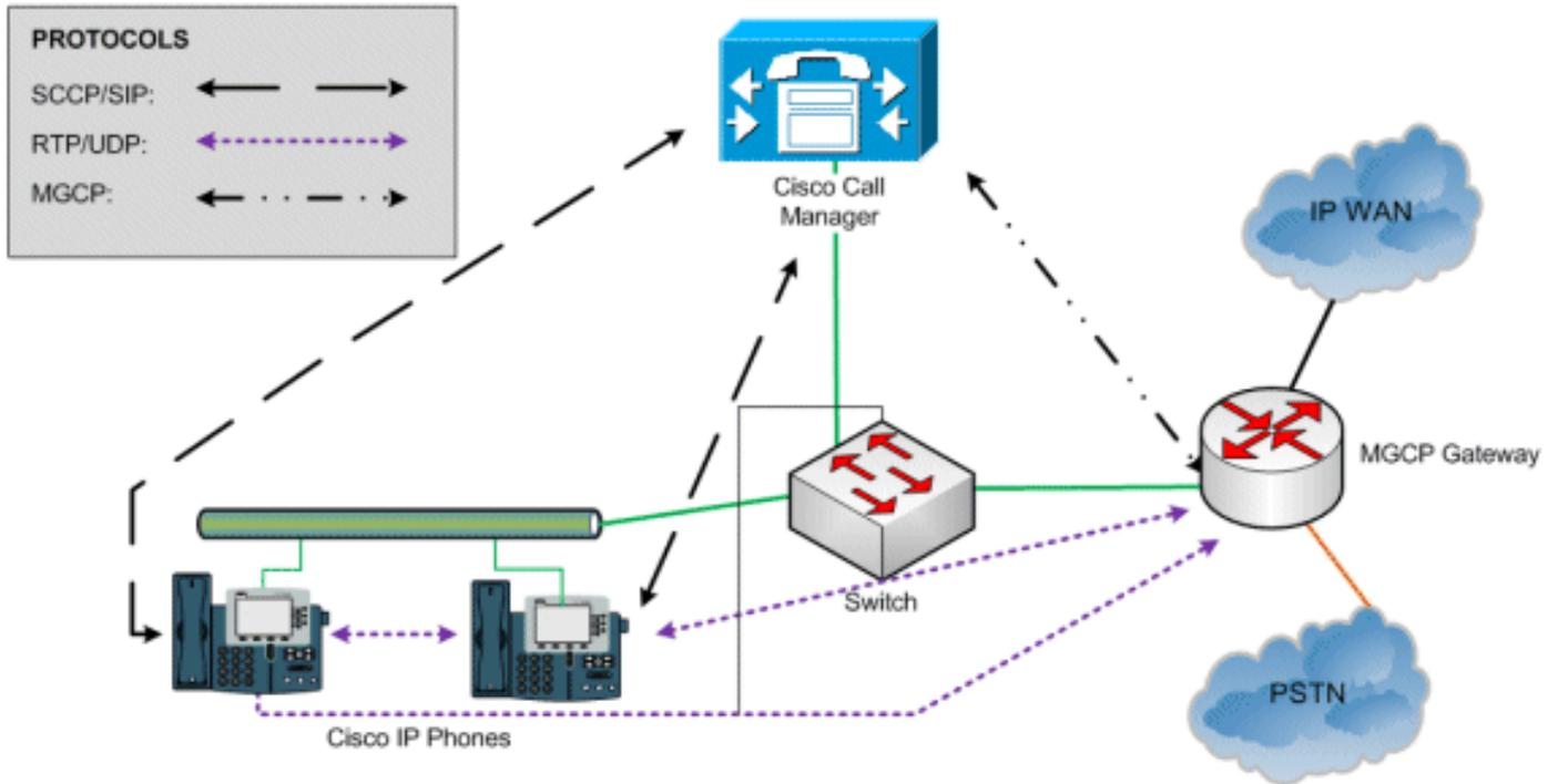
이 예에서 Cisco IP 전화기는 SCCP(Skinny Call Control Protocol)를 사용하여 Cisco CallManager와 통신합니다. 실제 음성 데이터는 두 디바이스 간에 RTP(Real-time Transport Protocol)를 통해 직접 전송됩니다. MGCP는 Cisco CallManager에서만 게이트웨이를 제어하는 데 사용됩니다.
