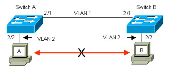
이 솔루션은 스위치 A와 B 간의 링크에서 ISL 트렁킹을 활성화하는 것입니다. 트렁킹은 트렁크 링크에 전송(멀티플렉스)하는 동안 각 프레임에 VLAN 헤더를 추가합니다.이렇게 하면 링크의 반대쪽 끝에 있는 스위치가 프레임을 분할할 수 있습니다.그런 다음 스위치가 적절한 VLAN 포트로 프레임을 전달합니다.
