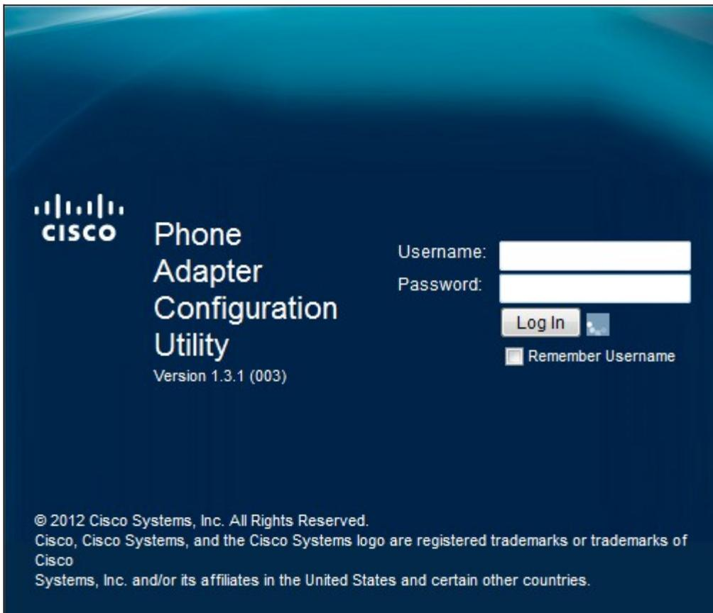
전화 어댑터의 기본 IP 주소는 192.168.15.1입니다. 웹 페이지가 나타나지 않으면 IP 주소를 재설정해 보십시오. IP 주소를 재설정하려면 재설정 버튼을 30초 동안 누릅니다. 이렇게 하면 기본 IP 주소와 다른 모든 설정이 공장 기본값으로 재설정됩니다. 또는 호스트 컴퓨터의 IP 주소가 알려진 경우 전화 어댑터와 동일한 서브넷에 있도록 수동으로 구성할 수 있습니다.
