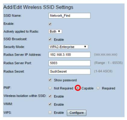
14단계. SSID 내에서 무선 격리를 허용하려면 **Enable** Wireless Isolation within SSID(SSID에서 무선 격리 활성화) 확인란을 선택합니다.무선 격리를 활성화하면 동일한 SSID에 연결된 클라이언트가 서로 ping할 수 없습니다.이 예에서는 Wireless Isolation with SSID가 활성화됩니다.
