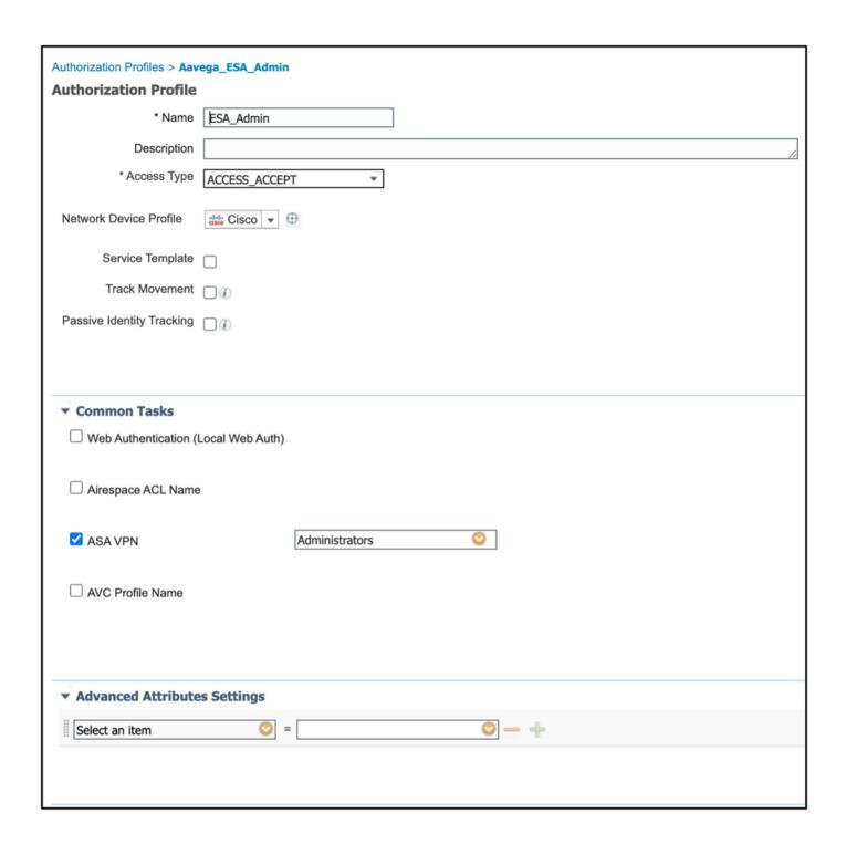
**참고:**radius 클래스 특성 25를 사용하고 이름을 지정합니다.이 이름은 AsyncOS(ESA/SMA)의 컨피그레이션과 일치해야 합니다. 그림 3에서 관리자는 CLASS 특성 이름입니다.
