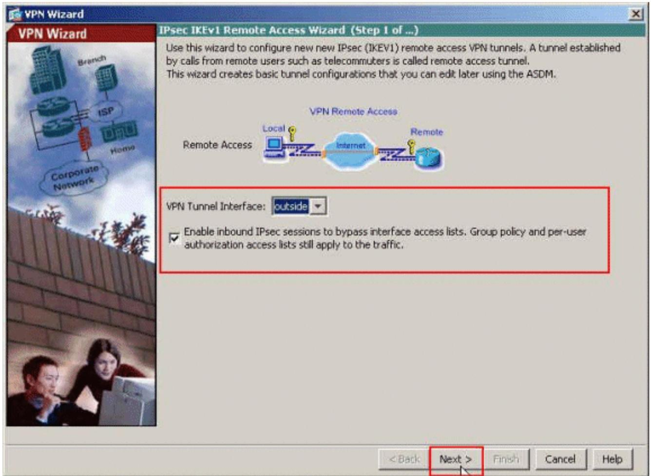
3. VPN Client Type(VPN 클라이언트 유형)을 Cisco VPN Client, Release 3.x 이상으로 선택합니다.Next(다음)를 클릭합니다
