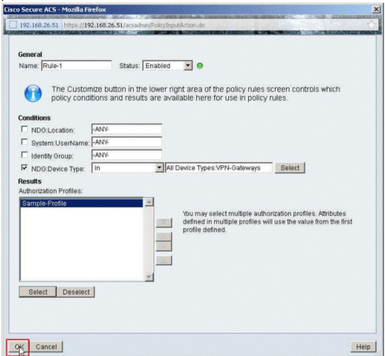
19. Rule -1이 NDG:Device Type as condition 및 Sample-Profile로 VPN-Gateways를 사용하여 생성되었는지 확인합니다.Save Changes를 클릭합니다
