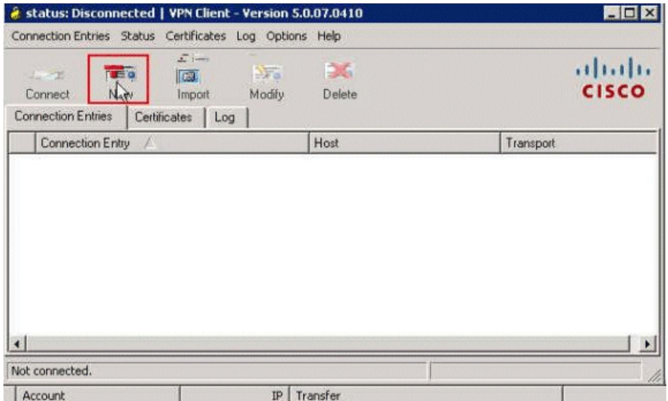
3. 새 연결의 세부 정보를 입력합니다. 설명과 함께 연결 항목의 이름을 입력합니다. Host(호스트) 상자에 ASA의 외부 IP 주소를 입력합니다. ASA에 구성된 대로 VPN 터널 그룹 이름(Cisco-Tunnel) 및 비밀번호(사전 공유 키 - cisco123)를 입력합니다. 저장을 클릭합니다
