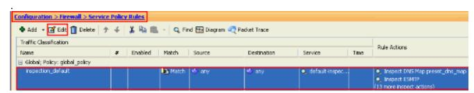
2. Edit Service Policy Rule(서비스 정책 규칙 수정) 창의 Rule Actions(규칙 작업) 탭 아래에 Protocol Inspection(프로토콜 검사)을 선택합니다. FTP 확인란이 선택되지 않았는지 확인합니다. 그러면 다음 이미지에 표시된 대로 FTP 검사가 비활성화됩니다. 그런 다음 확인을 클릭하고 적용을 클릭합니다
