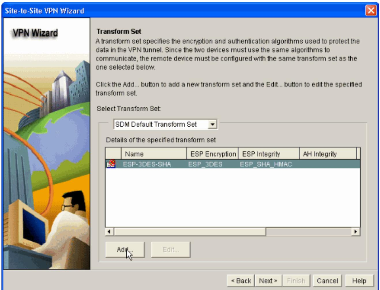
11. Transform Set 세부 정보(Encryption and Authentication Algorithm)를 제공하고 표시된 대로 OK(확인)를 클릭합니다
