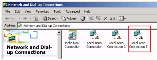
10. NIC 어댑터를 조합하고 새 연결을 구성하면 개별 NIC 어댑터가 비활성화되고 기존 IP 주소를 통해 액세스할 수 없습니다.고정 IP 주소, 기본 게이트웨이, DNS/WINS 설정 또는 동적 컨피그레이션을 사용하여 새 연결을 구성합니다.
