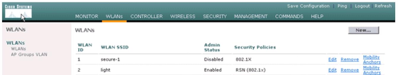
새 SSID를 사용하는 경우 다른 컨피그레이션은 필요하지 않습니다. 기존 SSID를 사용하는 경우 Catalyst 6500 WSLM과 Catalyst 6500 WiSM 간의 모빌리티 문제를 방지하기 위해 한 번에 하나의 RF 도메인만 업그레이드하십시오. WLAN이 구성되면 WLAN 정책이 올바른지 확인합니다. 예: ACL, QoS 등 Cisco WCS가 실행 중이고 Cisco WiSM을 관리하도록 구성할 준비가 되었는지 확인합니다.
