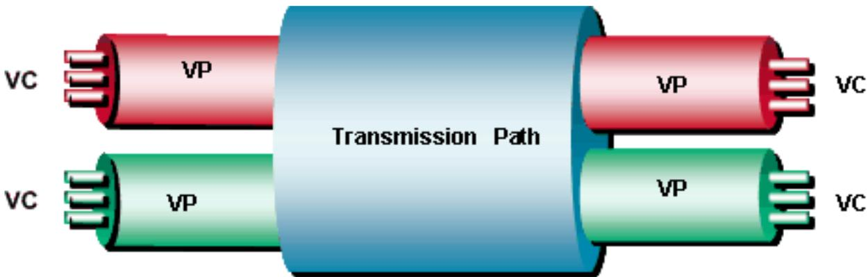
위 [다이어그램](#)에서 VC에 도착하는 ATM 셀은 셀 헤더의 VPI 및 VCI 번호를 기반으로 전환됩니다. 반면 VP에 도착하는 ATM 셀은 VPI 번호만을 기준으로 전환됩니다. ATM 스위치의 구성은 스위치가 각각 특정 VPI/VCI 쌍 또는 VPI에 대해 VC 또는 VP 스위치여야 하는지 결정합니다.
