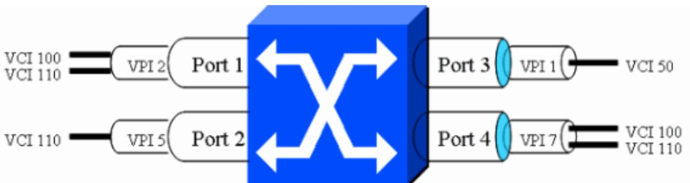
스위치의 예정된 포트에서 발신 포트로 트래픽을 전환할 수 있습니다. 예를 들어 포트 1 VPI/VCI 2/100에서 오는 모든 트래픽이 포트 4 VPI/VCI 7/110으로 스위칭되는지 확인할 수 있습니다. 이와 같이 포트 2 VPI/VCI 5/110에서 포트 4 VCI/VPI 7/100으로 트래픽을 전송하도록 ATM 스위치를 구성할 수 있습니다. 이 [표는패킷에서 전환되는 방법을 보여줍니다. VPI/VCI를 다른 VCI로 연결합니다.](#) 이는 VPI 및 VCI 정보를 사용하여 트래픽을 전환하기 때문에 VC 스위칭입니다.
