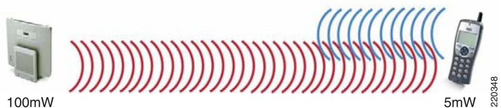
図 9-13 クライアントと AP の電力の一致
