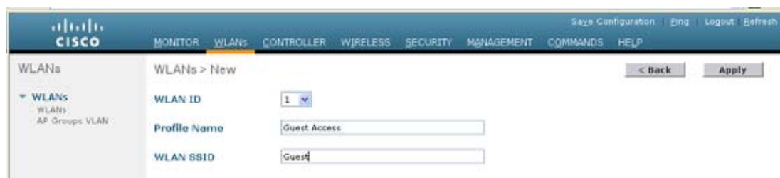
図 10-17 ゲスト WLAN SSID の定義
