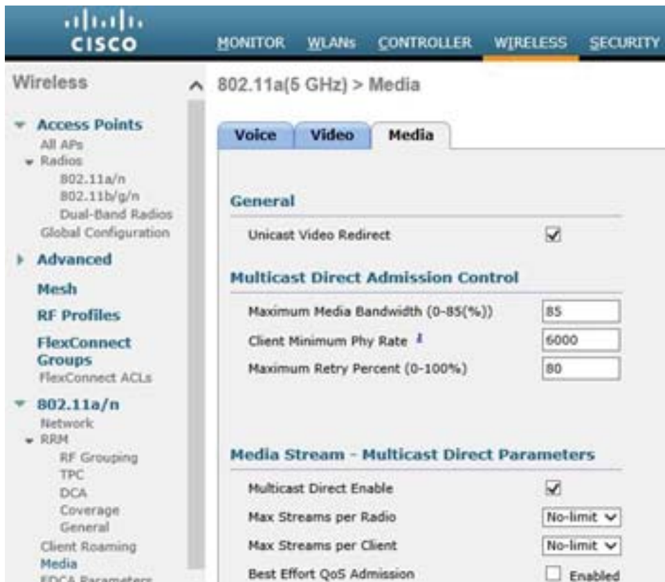
図 5-22 WLC の [802.11a (5 GHz) Media] ウィンドウ
