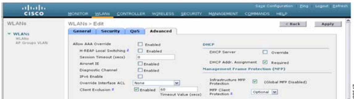
図 10-23 ゲスト WLAN の高度な設定
