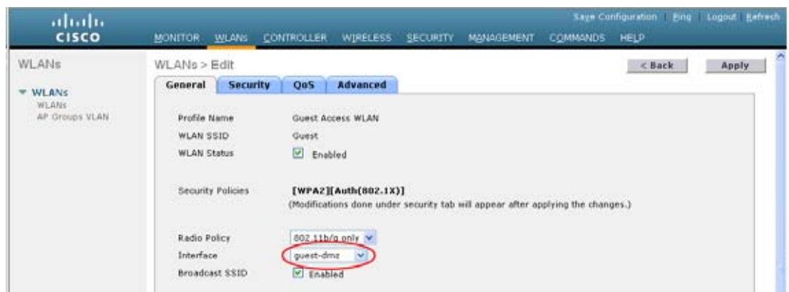
図 10-28 アンカー WLC ゲスト WLAN インターフェイスの設定
