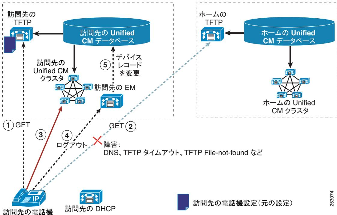
EMCC ログインモードでは、ホーム クラスタへの接続障害を検出した電話機は、そのホーム クラスタへの接続を再確立しようとします。WAN 障害などの障害によって再確立が何度か失敗した後、電話機は訪問先クラスタにログアウト要求を自動的に発行し、ログアウト時に訪問先クラスタに再登録します。
