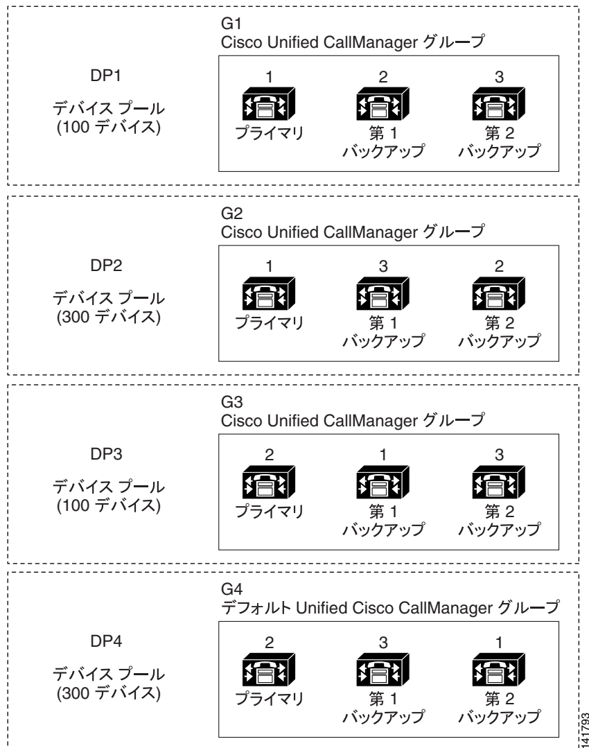
図 7-2 分散型コール処理と組み合わせた冗長化
