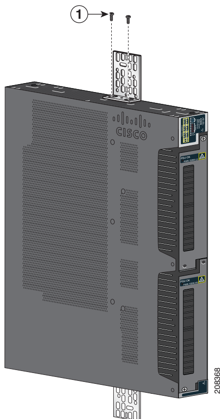
図 2-9 19 インチ ラック ブラケットの取り付け
