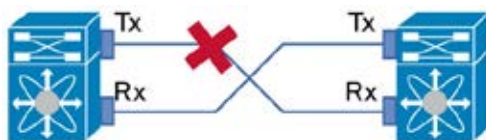
図 48. UniDirectional Link Detection (UDLD; 単方向リンク検出)
