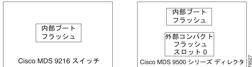
図 1-2 Cisco MDS 9000 スーパーバイザ モジュールのフラッシュ デバイス
