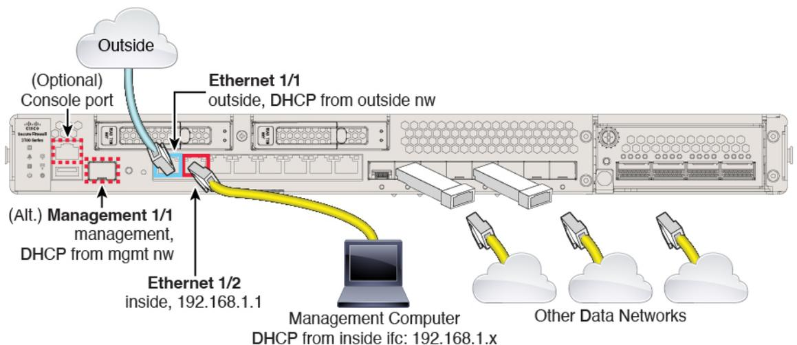
Management 1/1 または Ethernet 1/2 のいずれかで Cisco Secure Firewall 3100 を管理します。デフォルト設定でも、Ethernet1/1 を外部として設定します。
