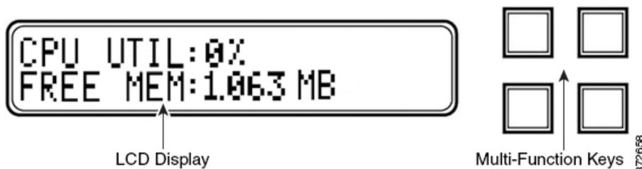
アイドルディスプレイモードでは、パネルに CPU 使用率および使用可能な空きメモリ容量と、シャーシシリアル番号が交互に表示されます。任意のキーを押すと [Idle Display] モードは中断し、[Network Configuration]、[System Status]、および [Information] モードにアクセスできる LCD パネルのメインメニューが表示されます。
