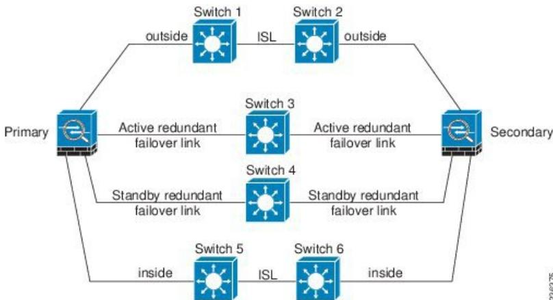
図 7: Inter-Switch Link (ISL) を使用した接続
