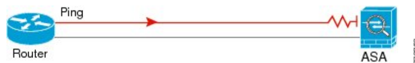
図 4: ASA の戻りルート未設定による ping の失敗
