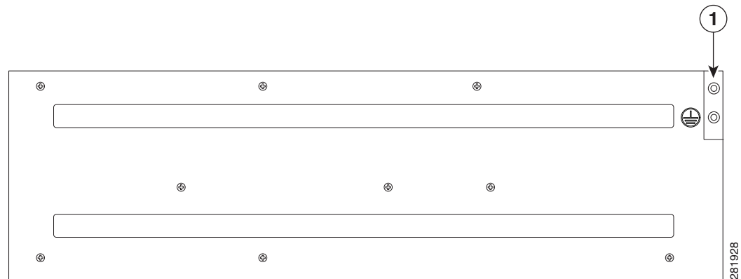
図 3-9 ルータの背面へのアースラグの取り付け
