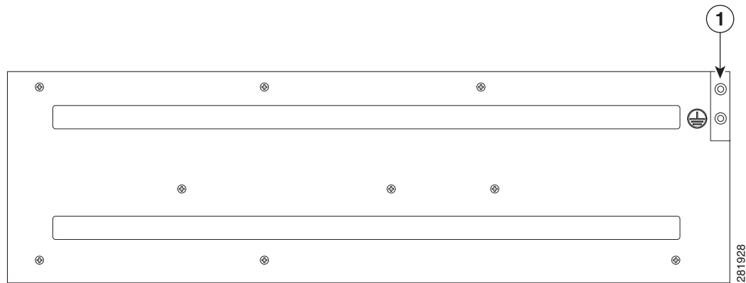
図 3-6 ルータの背面へのアースラグの取り付け
