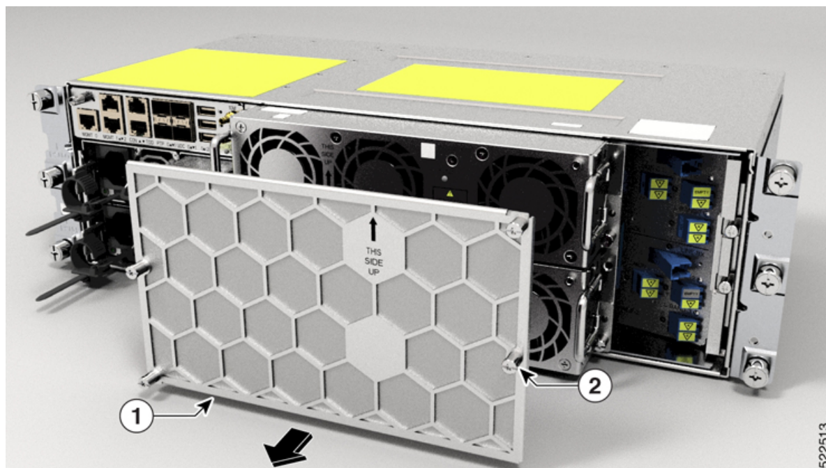
図5: ファンフィルタの取り外し
