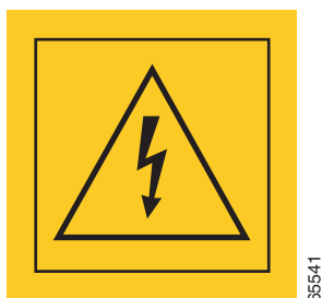
図 2-5 感電危険性ラベル
