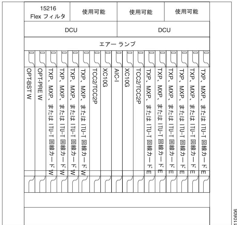
図 3-36 FlexLayer フィルタを使用する増幅 TDM の例
